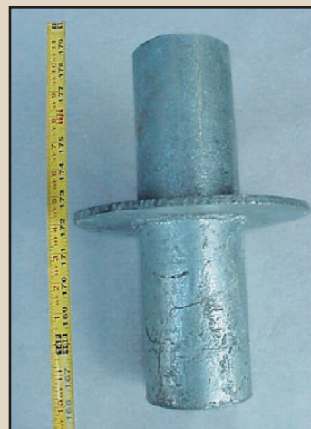
Figura 2: Camisa de pared galvanizada enviada para prueba
