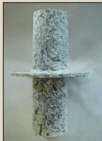
Figura 4: Camisa de pared galvanizada después de 500 horas de exposición
