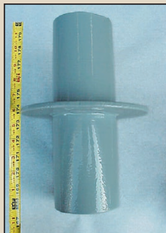
Figura 1: Revestimiento de pared Gal-vo-plast® presentado para prueba
