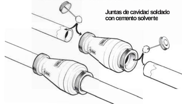
CERCIÓRESE QUE EL PRIMER O EL CEMENTO SOLVENTE NO ENTREN EN CONTACTO CON LOS COMPONENTES INTERNOS DE LA VÁLVULA.
