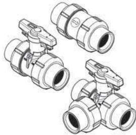
**INFORMACIÓN DE LA INSTALACIÓN ESPECIAL:** Las válvulas de bola tipo True Unión utilizan conectores finales desprendibles. Para evitar problemas, NUNCA MONTE LA TUBERÍA CON LOS CONECTORES FINALES MIENTRAS QUE SE UNEN AL CARTUCHO DE LA VÁLVULA.
