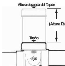
**PASO2** En la tabla 3, la dimensión "D" se utiliza para calcular la longitud del tubo de subida y del de la manija.
