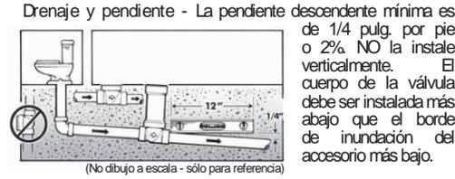
Localización y acceso de la válvula Siempre que sea posible, sitúe el cuerpo de la válvula / tapón de acceso en una zona abierta y expuesta, para facilitar el servicio.
