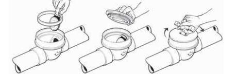
**PRECAUCIÓN -** No permita que el cemento solvente para entrar en contacto con el cuerpo interno o el ensamble del columpio. Esto podría impedir un sellado y funcionamiento correcto.
