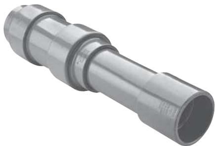
Las juntas de expansión de Spears® permiten un movimiento telescópico de un tubo interno montado firmemente dentro de una manga externa para acomodar la expansión y contracción de un sistema de tubería. Está disponible en una variedad de tamaños nominales de tubería con longitudes de recorrido máximas de 6 ó 12 pulgadas. Las juntas de expansión de Spears® también se pueden utilizar como acoples de reparación
