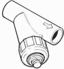
Los Filtros en Y pueden ser montados en posiciones verticales y horizontales. Sin embargo, debe prestarse atención a la dirección del flujo como se indica en el cuerpo del filtro. La canasta del filtro debe ser puesta apuntando hacia abajo para recolectar sedimentos apropiadamente y facilitar su limpieza.
