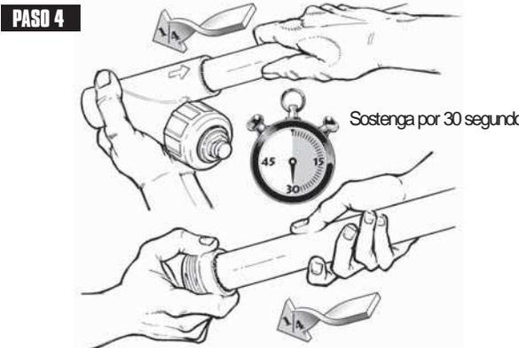
Permita que la unión se seque conforme a las especificaciones del fabricante del cemento solvente.
